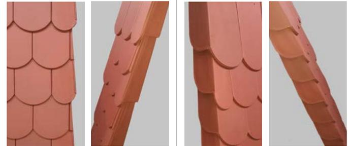
Ein 3er-Ortgang kann bei Doppel- und Kronendeckung verwendet werden. Der 3er-Ortgang ist ein halber Ziegel mit einem schmälere Ortganglappen. Es werden 3 Stück pro Meter benötigt.
